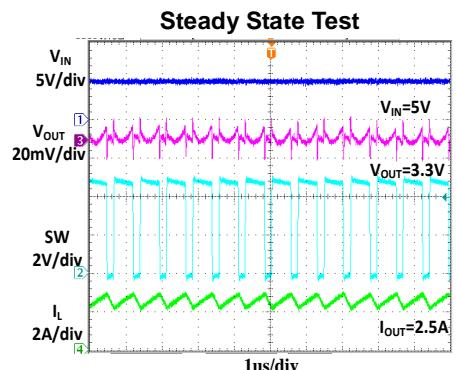
$C_{IN}=10\mu F$ ,  $C_{OUT}=10\mu F$ ,  $L=1\mu H$ ,  $TA=+25^{\circ}C$
